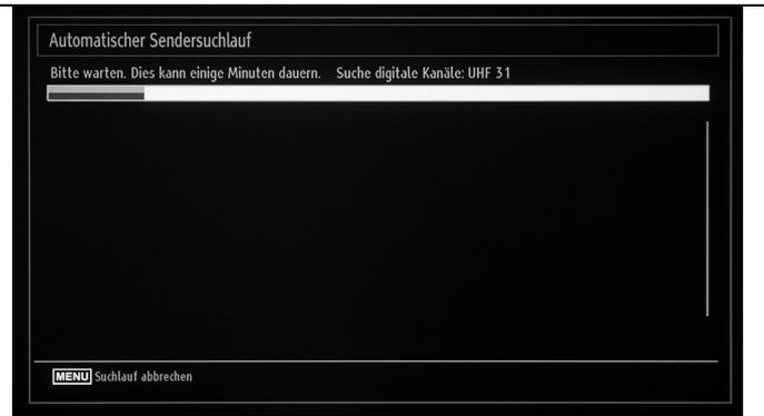
Nach dem Ende der automatischen Programmspeicherung erscheint die Kanalliste (siehe Menü **Programmliste**, Untermenü **Kanalliste bearbeiten** auf Seite 27). Wenn die Liste nicht weiter bearbeitet wird, schließt sie sich nach ein paar Minuten.
