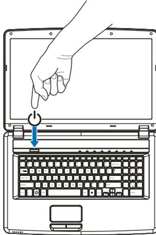
Die Betriebsanzeige informiert Sie über den Betriebszustand. Unabhängig vom Betriebssystem wird das Notebook ausgeschaltet, wenn der Schalter länger als 4 Sekunden ununterbrochen betätigt wird.
